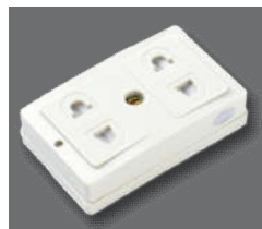
Ổ cắm OUSa S020 16A 250V Có màng che an toàn. Series: OC 82 SL: 1 cái/hộp 100 cái/thùng
